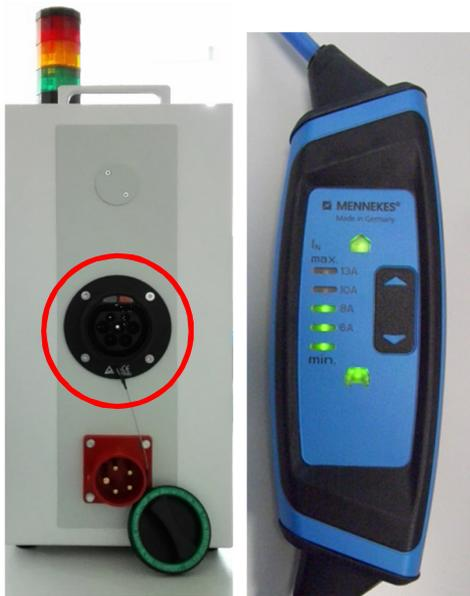
Die Kommunikation mit dem Fahrzeug über den CP-Kontakt beginnt. Durch ein PWM-Signal wird die Ladestromobergrenze an das Fahrzeug übermittelt. Gleichzeitig wird die Schutzleiterverbindung überprüft. Bei fehlendem Schutzleiter oder fehlerhafter Installation leuchtet ein Warnsymbol am Ladekabel.
